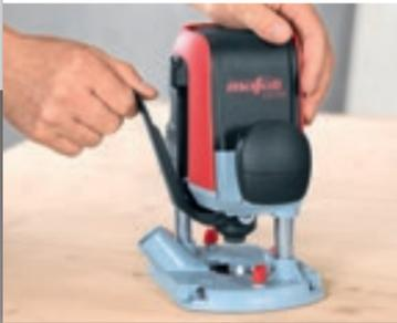
Entièrement nouveau et seulement chez MAFELL : avec le système innovant de remplacement de la fraise, votre machine est opérationnelle en quelques secondes. Il suffit de lâcher le levier de verrouillage, changer la fraise, remettre en place le levier, et c'est prêt ! Et le tout sans outils.
