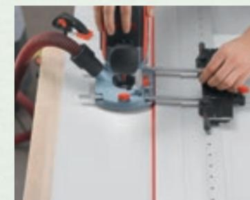
En combinaison avec l'adaptateur de défonceuse LO-FA et le rail de guidage F-LR, vous pouvez percer des rangées de trous en toute sécurité et avec précision. Pour avancer rapidement dans votre travail, il vous suffit de désactiver la fonction Permax.
