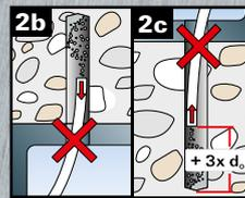
Pour perçage vertical: Profondeur ancrage + 3xØ de perçage
